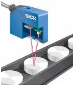
Fig. 155 Voorbeeld van een optische naderingsschakelaar. (opengewerkt). Zender en ontvanger in een behuizing.
