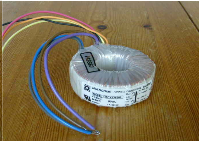
Fig. 46 Ringkern transformator 2x 9V 50 VA
