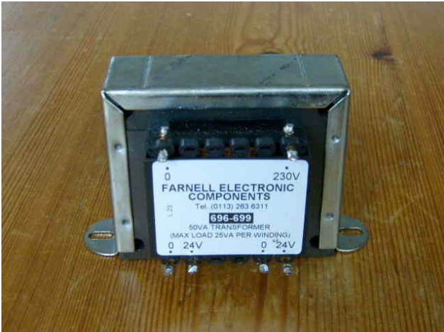
Fig. 45 E-I kern transformator 2x 24 V 50 VA
